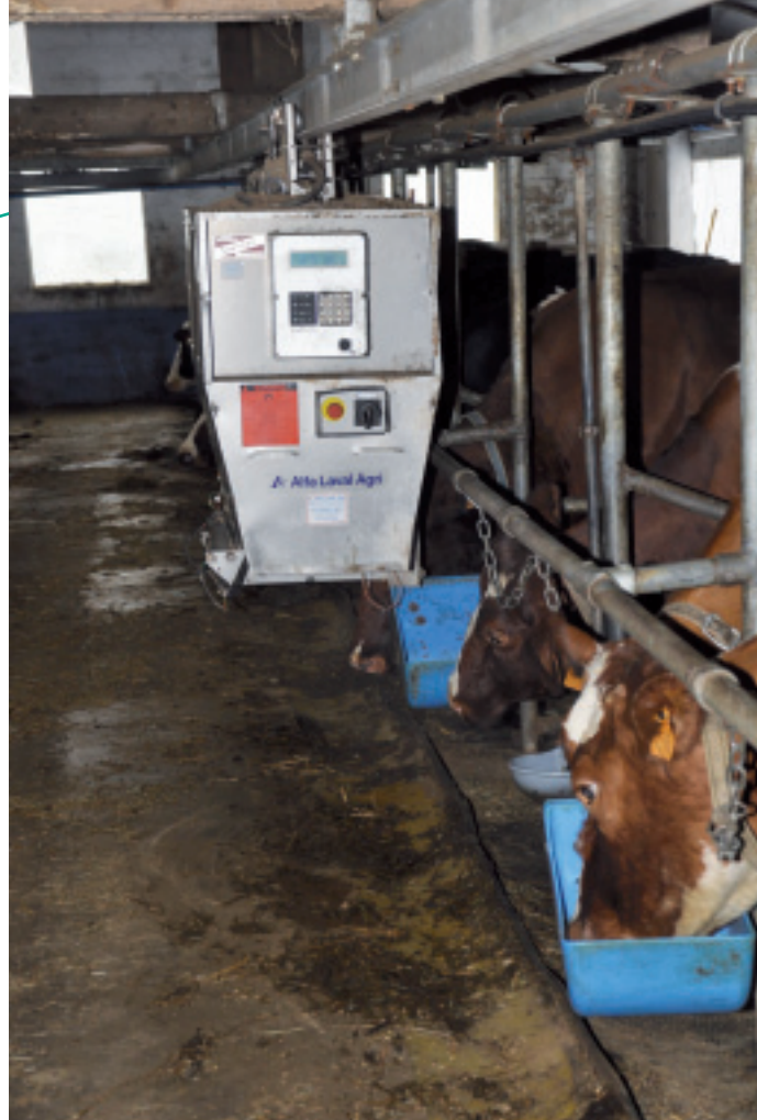
Les concentrés sont distribués via un robot sur rail
