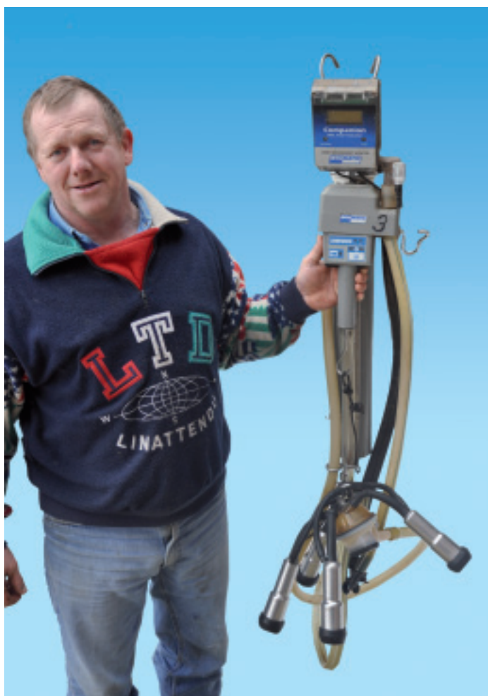
Les griffes sont dotées d'un compteur à lait et d'un décrochage automatique
